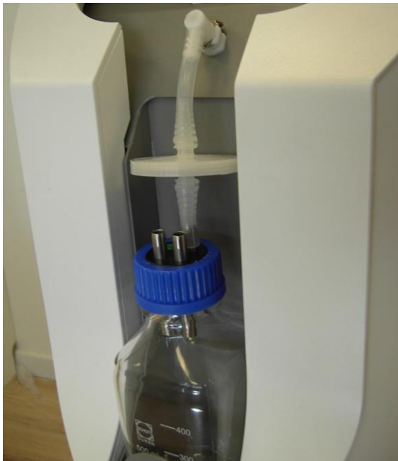
Figura 3-44. Filtro montado instalado
