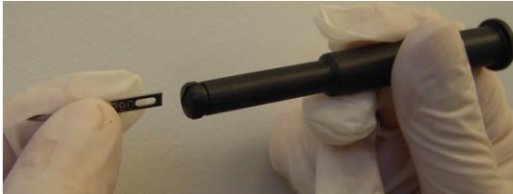
Figura 3-69. Inserción de la hoja de incisión en la ranura del soporte de hoja
