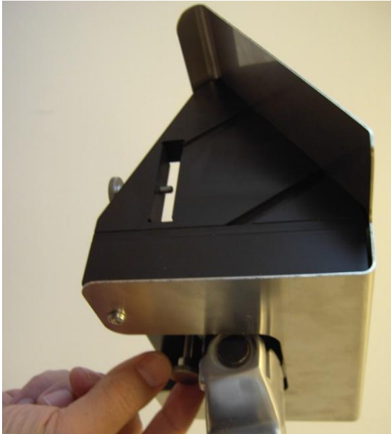
Figura 3-12. Ajuste del tornillo de apriete manual de la bandeja de piezas manuales
