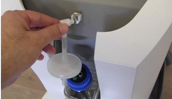
Figura 3-41. Conexión del filtro montado al conector de vacío del sistema
