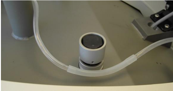
Figura 3-63. Ubicación de la inserción gruesa del tubo de extracción al lado de la electroválvula izquierda
