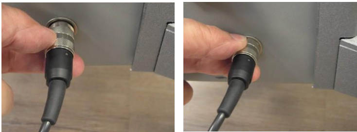
Figura 3-25. Conexión del cable del interruptor de pie izquierdo en la parte trasera del sistema
