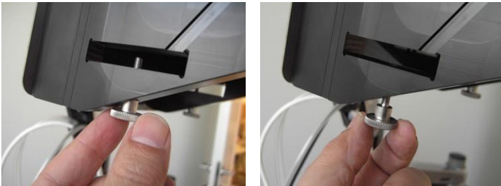
Figura 3-18. Aflojamiento del tornillo de apriete manual del portacubeta
