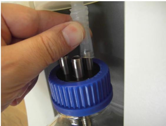
Figura 3-42. Conexión del tubo de vacío al frasco de residuos
