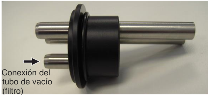
Figura 3-43. Tubo de vacío (filtro) que se conecta al conducto más corto del tapón
