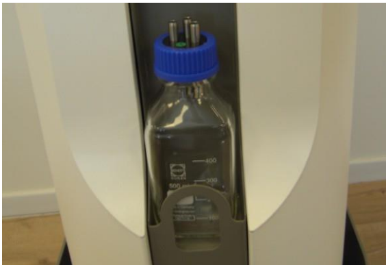
Figura 3-36. Frasco de residuos ubicado en su espacio en el sistema
