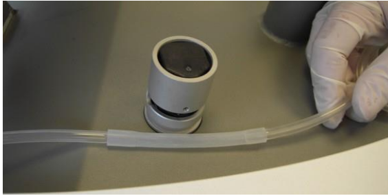
Figura 3-88. Ubicación de la inserción gruesa del tubo de implante al lado de la electroválvula derecha
