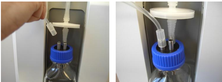
Figura 3-61. Conexión del tubo de extracción al frasco
