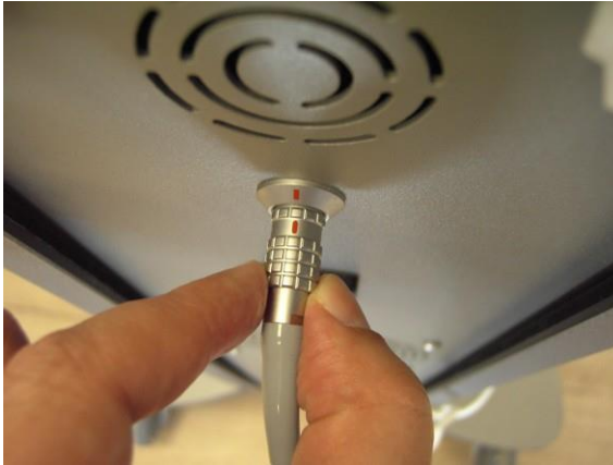
Figura 3-46. Conexión del conector del cable de la pieza manual
