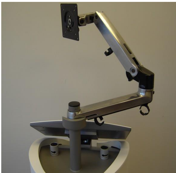
Figura 3-7. Brazo articulado instalado
