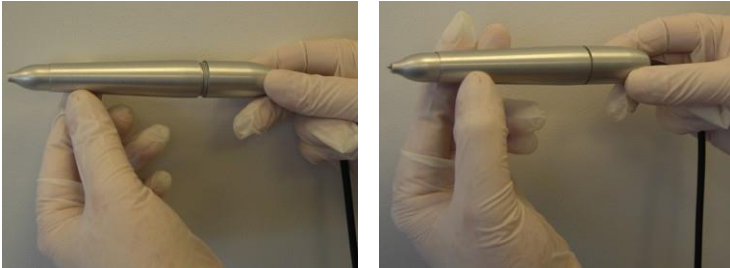
Figura 3-73. Enroscado del cuerpo a la base de la pieza manual
